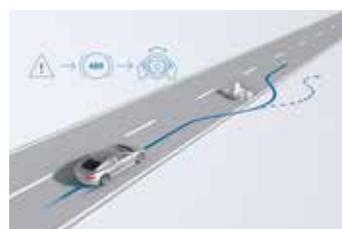
*Dank ABS bleibt das Fahrzeug auch bei einer Vollbremsung lenkbar und kann Hindernissen ausweichen.*
