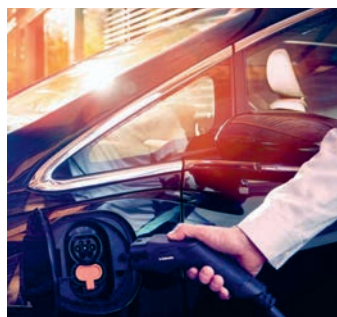
Der sogenannte Typ-2-Stecker wurde von der Europäischen Kommission als Standard für Elektroautos definiert. Foto: djd/Webasto/Derek Henthorn
