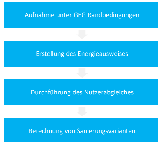
Abbildung 24: Ablauf bei der Erstellung eines Gebäudeenergieausweises
