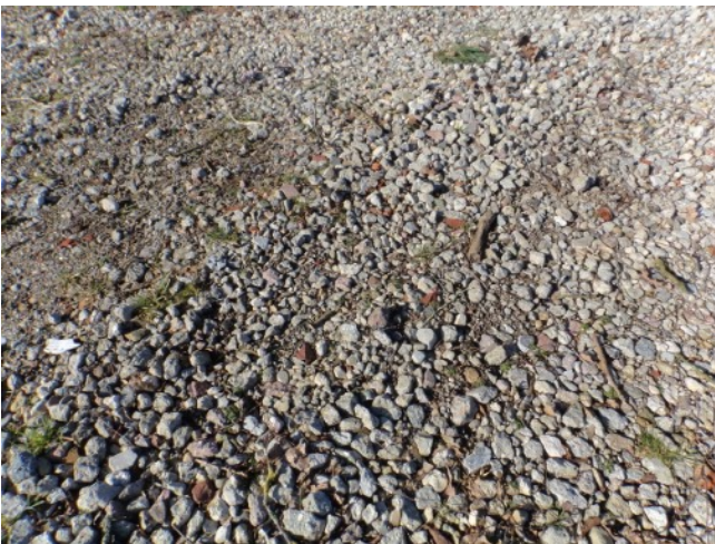
Foto 3: Detail des aufgebrachtten Recyclingmaterials aus dem Abbruch des ehem. Durckereigebäudes
